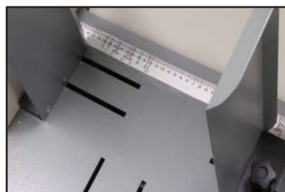
Fácil ajuste de la recepción con capacidad de 150 mm
